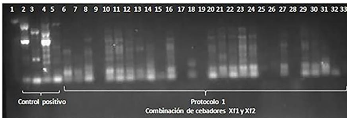
Figura 2. Visualización de los productos de amplificación PCR iniciadores SCAR Xf1-Xf2 en gel de agarosa 1,5%. Marcador de 50pb (pozo 1); controles positivos de X. albilineans (pozos 2-5); ADN extraído de 28 muestras de semillas provenientes de plantas inoculadas con X. phaseoli de 28 accesiones de caraota.
