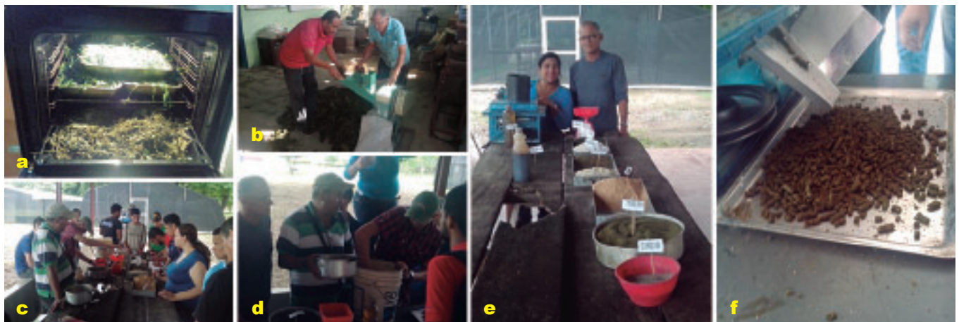
Foto 3 a, b, c, d, e y f. Proceso de elaboración del alimento para animales (Deshidratado de materia prima, molienda, mezclado y pelletizado).
