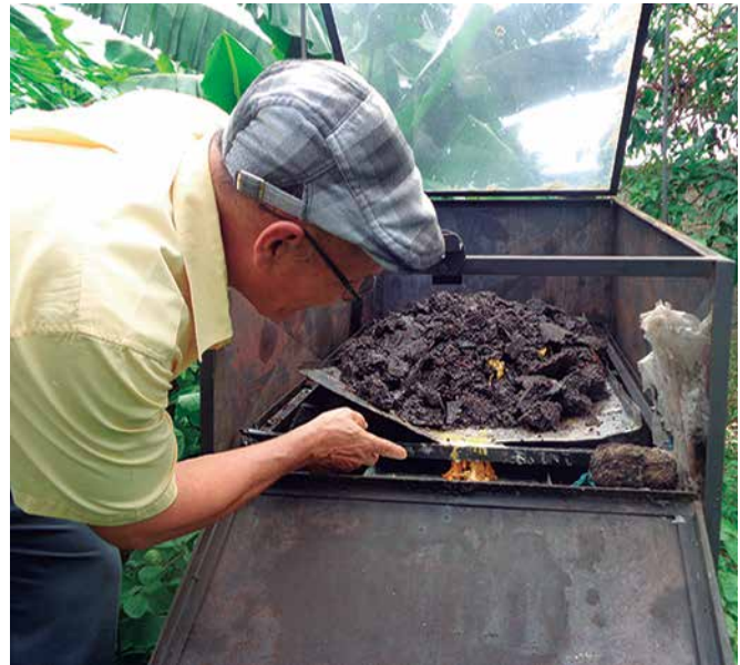
Foto 6. Extractor solar de cera, el residuo de color oscuro se usa como material combustible.
