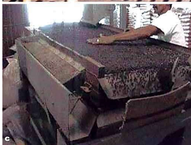
Foto 11 a, b y c. Limpieza de semilla de caraota en planta de procesamiento: a) Semilla en tolva de limpiadora, b) Separación de impurezas y c) Separación densimétrica.
