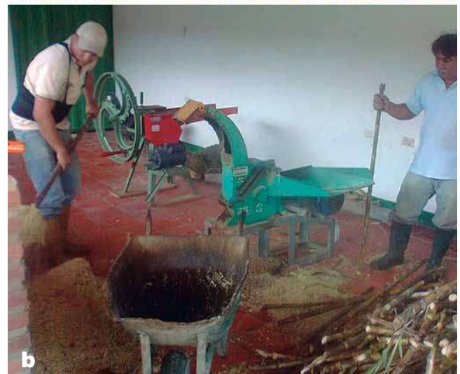
Foto 4. a) Apronte de la materia prima; b) repicado de caña en picadora de alta revolución.
