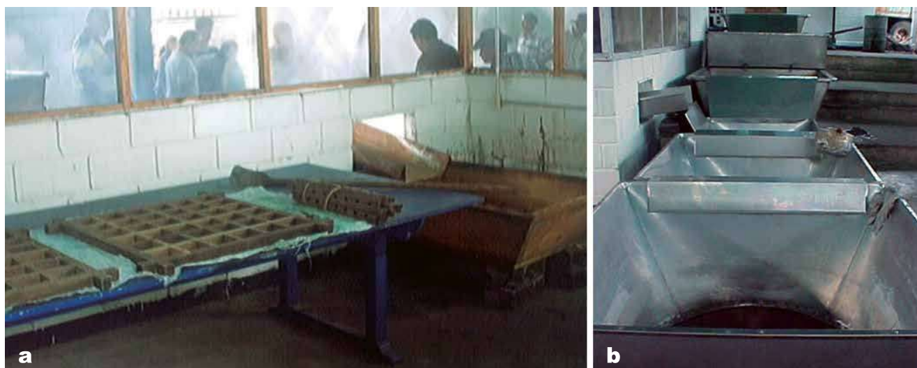
Foto 6. a) Sala de batido y moldeo de central de beneficio de caña; b) vista de tren de pailas.
