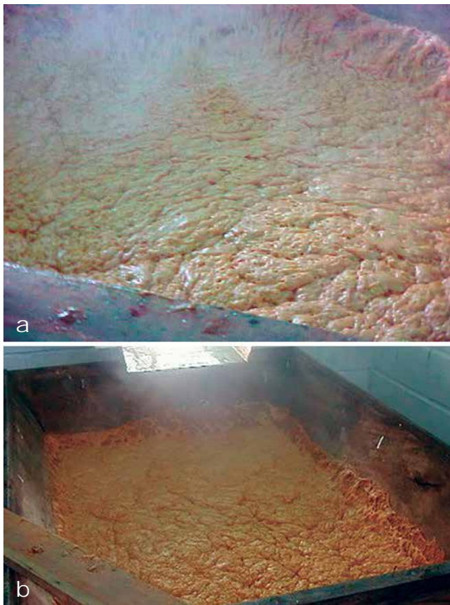
Foto 11 a y b. Abultamiento de las mieles por choque térmico.
