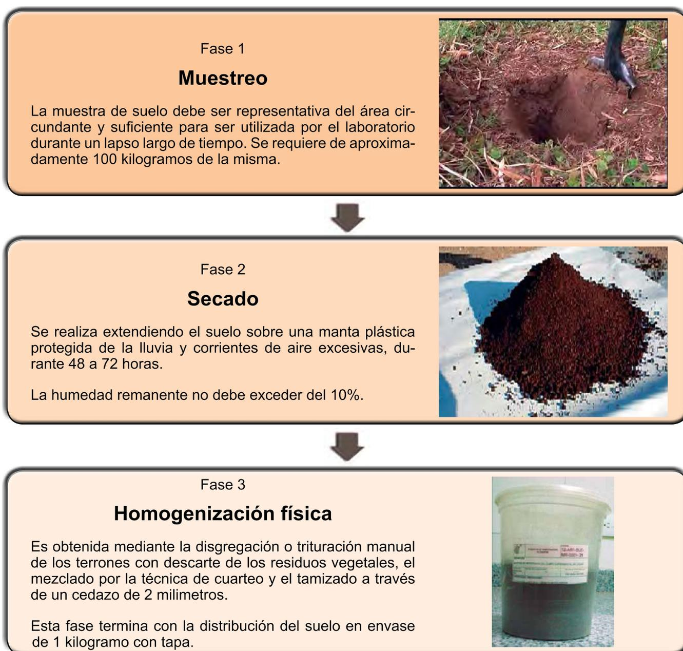
**Figura.** Esquema de la preparación de la muestra control según protocolos del INIA.
