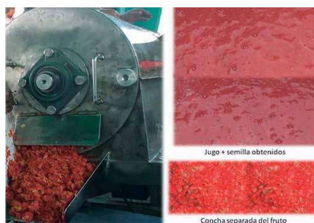
Figura 3. Método de extracción mecánica.
