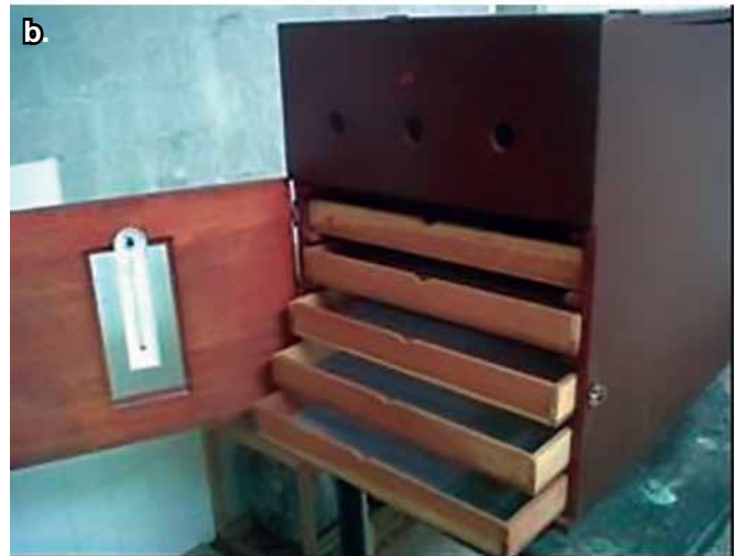
Foto 6 a y b. Incubadora artesanal mostrando sus seis bandejas y termómetro.
