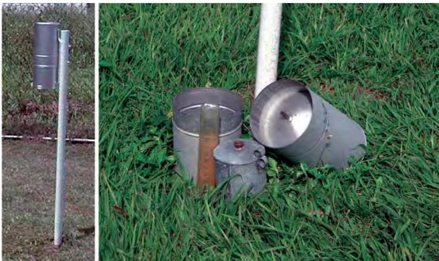
Foto. Detalles del pluviómetro de cántaro.
