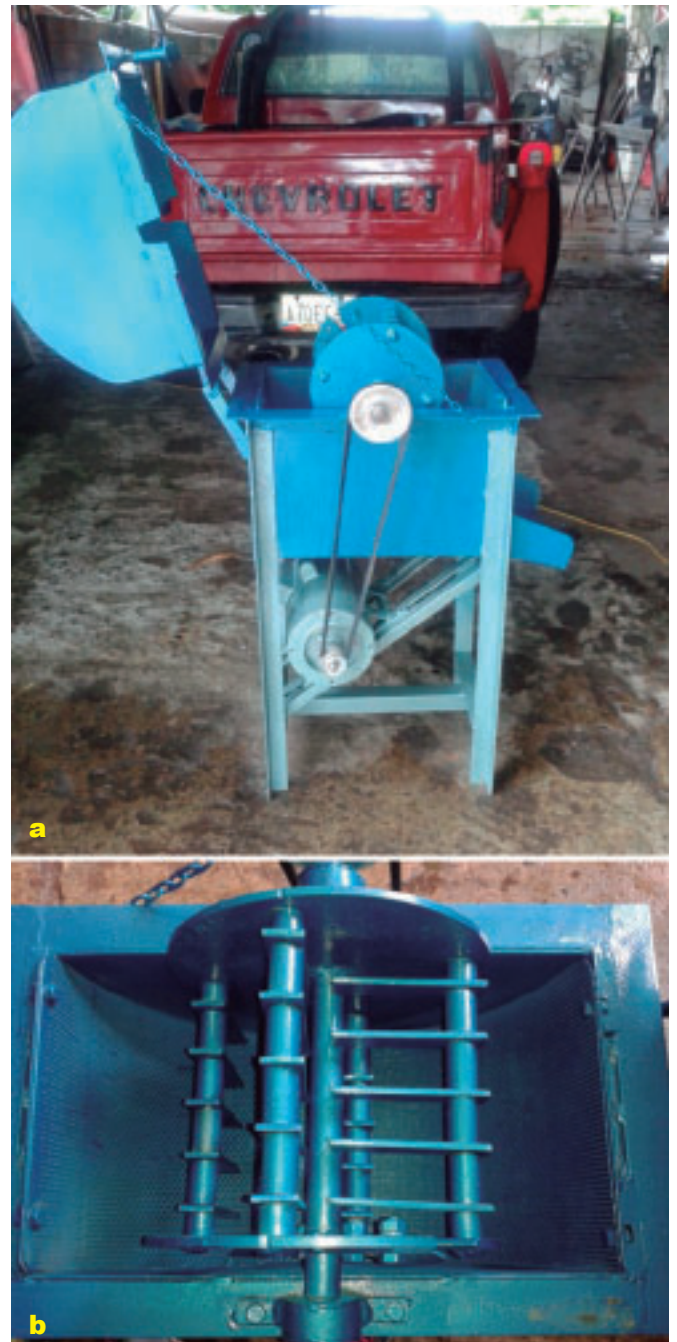
Foto 2 a y b. Molino martillos y cuchillas.
