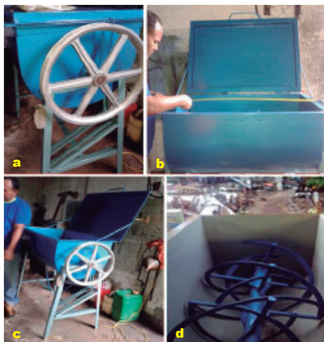
Foto 4 a, b, c y d. Mezclador artesanal de tornillo sin fin.
