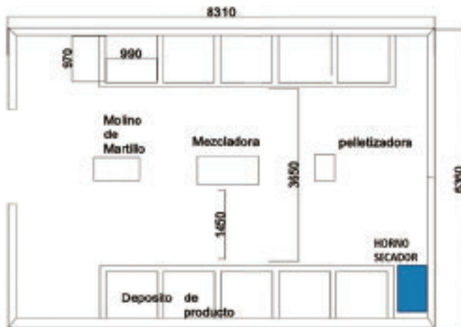
Figura 1. Distribución espacial de equipos y área requerida para la unidad modelo artesanal de elaboración de alimento para uso animal.
