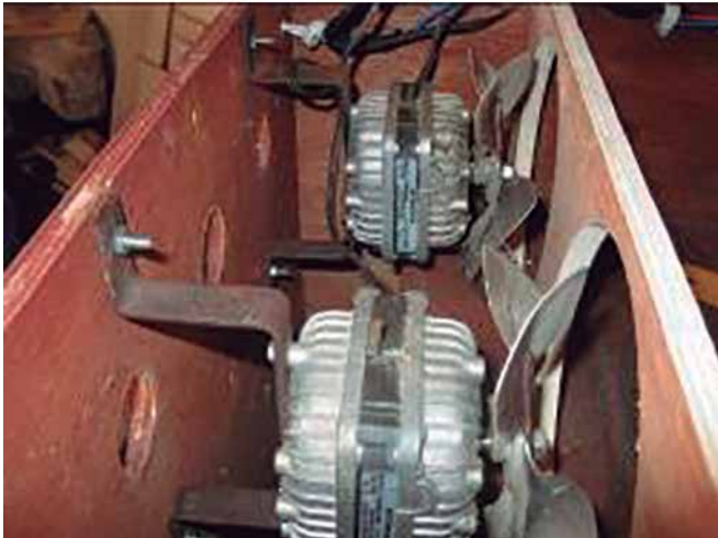
Foto 6 a y b. a) Proceso de embriodiagnóstico y b) Adaptación de ventiladores a incubadora artesanal.
