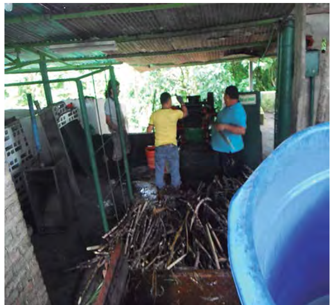
Foto 2. Molienda de caña en trapiche para obtención del jugo.
