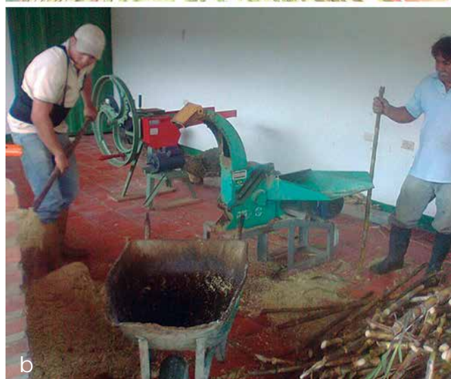
Foto 4. a) Apronte de la materia prima; b) repicado de caña en picadora de alta revolución.
