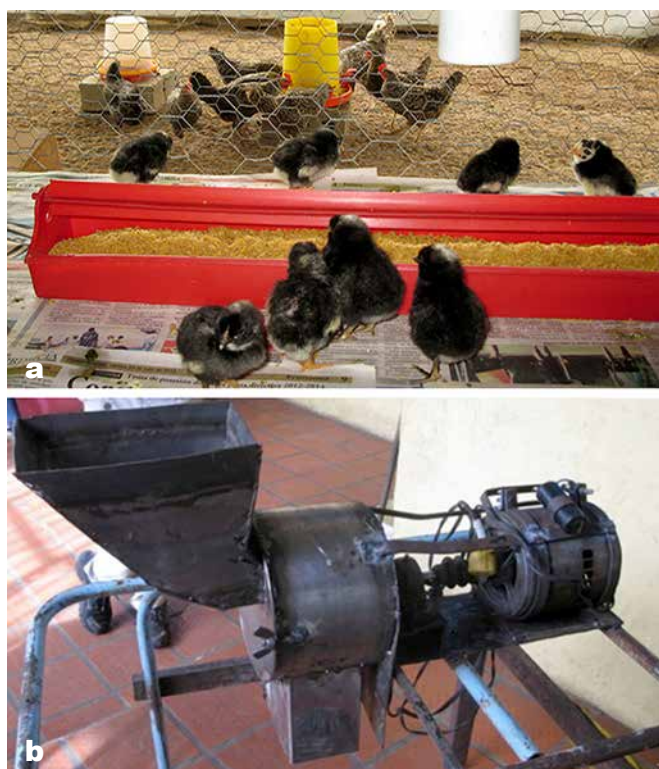
Foto 5. a) Pollitos y lote de gallinas alimentados con fórmulas comerciales y b) Equipo de molienda artesanal de granos de maíz construido en acero inoxidable por innovadores del municipio Caroní.
