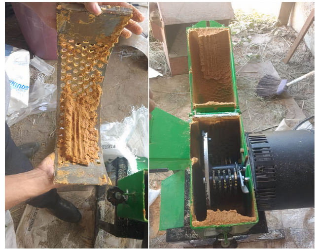
Figura 1. Peneira usada no triturador de forragem para resíduos de panificação incluídos na dieta da codorna japonesa em fase de postura. Arapiraca, Brasil
